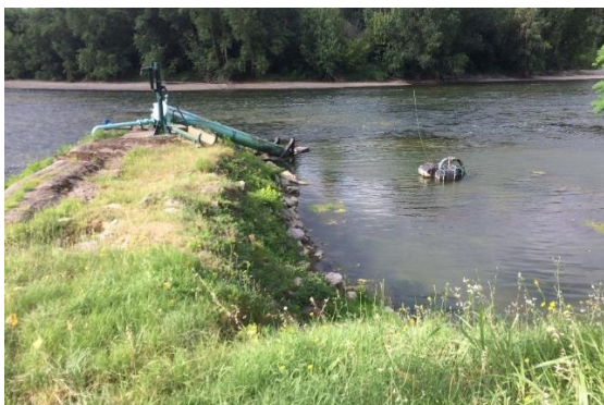
Vue du pompage de surface mobile (gauche) et du système de pompage de secours (droite)
