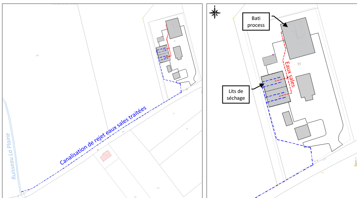
Figure 19 : Schéma de la canalisation de rejet vers le ruisseau de la Plaine (situation future)
